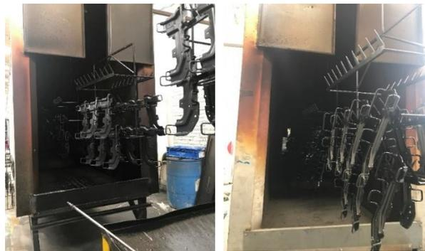
FIGURA 18. ENTRADA Y SALIDA DEL HORNO (CURADO)
