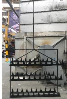
FIGURA 8 RACKS UTILIZADOS PARA EL PROCESO E-COAT
